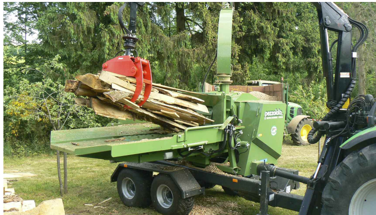
Lors d'une démonstration : la grue alimente le déchiqueteur puis les plaquettes forestières sont projetées dans la benne
